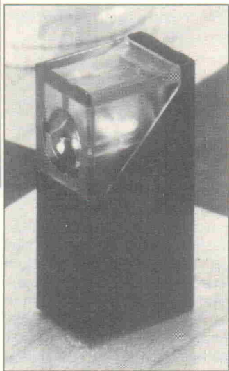
Bild 6. Sehr kleine Lichtschranke für den industriellen Einsatz. Maße: 22 x 11 x 8 mm.
